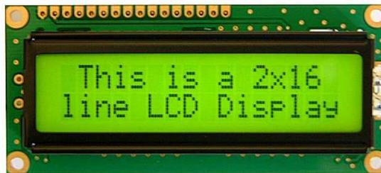
Gambar 3.1 LCD 16x2
